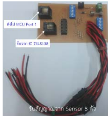
แผงวงจรเชื่อมต่อกับอินพุตของหน้าสัมผัสจากชุดตรวจรู้ทางแสง
