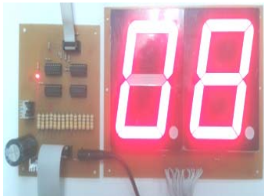
การแสดงผลของหลอดLED แบบ 7ส่วน เมื่อพื้นที่ร่ว่งจำนวน 8 คัน
