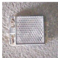
โครงสร้างของตัวตรวจรู้ทางแสงและแผ่นสะท้อนที่ใช้ในงาน
