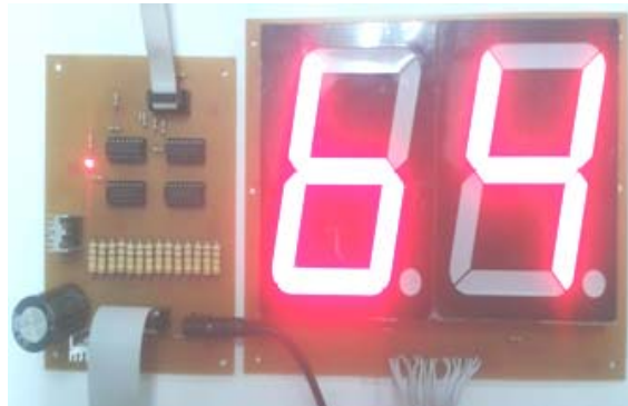
การแสดงผลของหลอดLED แบบ 7 ส่วน เมื่อพื้นที่ร่ว่งจำนวน 64 คัน
