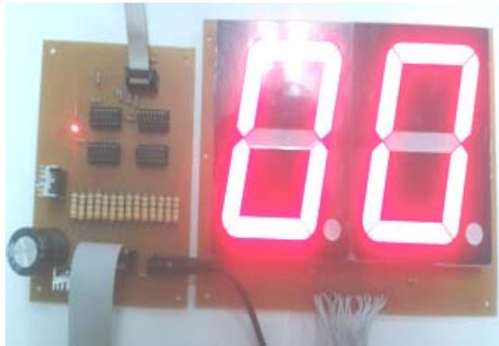
การแสดงผลของหลอดLED แบบ 7ส่วน เมื่อพื้นที่ร่ว่งจำนวน 0 คัน
