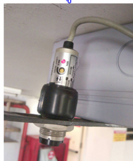
โครงสร้างของตัวตรวจรู้ทางแสงและแผ่นสะท้อนที่ใช้ในงาน
