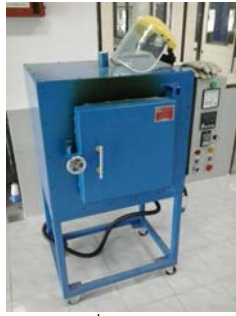
เตาเผาที่ใช้ในการทดลองแบบดิจิทัล 1200 องศา
