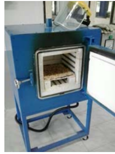
เตาเผาที่ใช้ในการทดลองแบบดิจิทัล 1200 องศา
